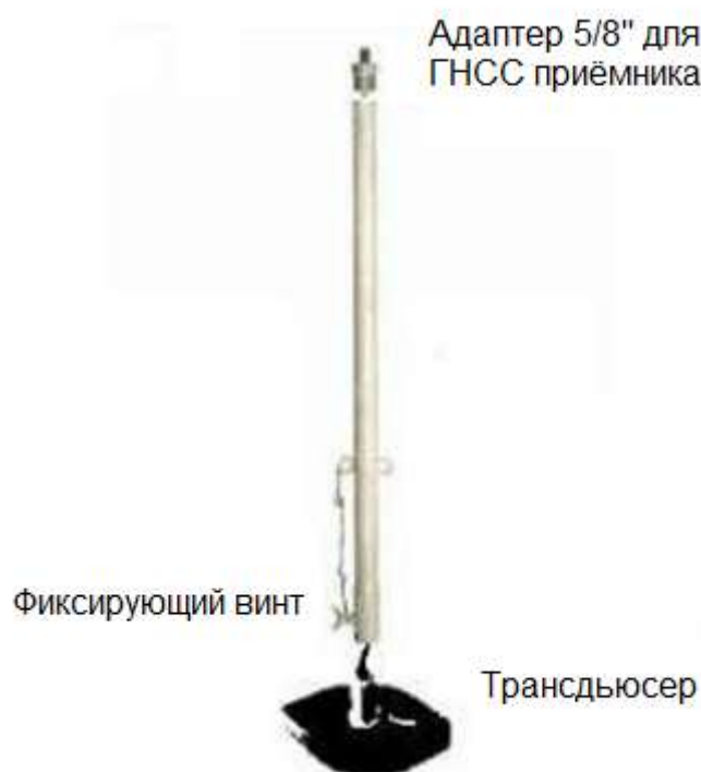
Рис. 2.4 Монтаж оборудования на вехе
